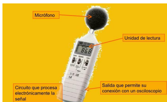
Figura 3. Sonómetro y sus Partes.
